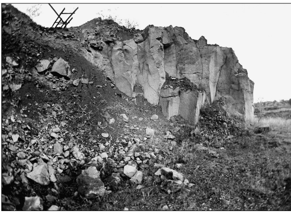
Abb. 164 Mayen, Grube Matthias Adorf, nördlich des Absetzbeckens. Nicht abgebaute Basaltlavasäulen bilden die Bruchgrenze zwischen den Parzellen A und B (Nachlaß J. Röder, Mus MY).
