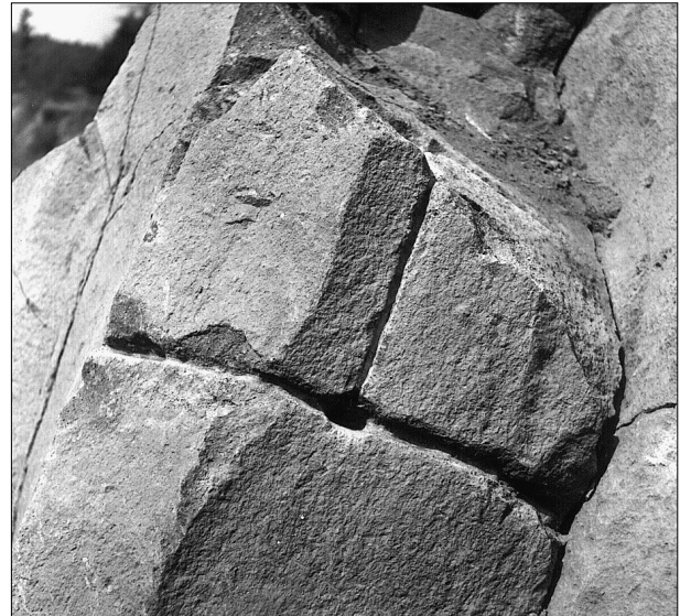
Abb. 97 Kottenheim, Grube TUBAG. Keiltaschenspaltungen des Typs TC. In als Sollbruchstellen gesetzten Keilrillen wurden zur Aufnahme von eisernen Keilen separate Keiltaschen eingetieft (Nachlaß J. Röder, Mus MY).
