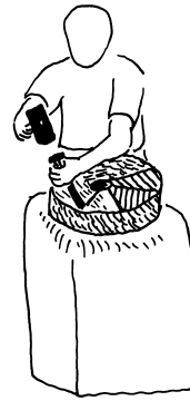
3.2: Anlegen der Schärfung der Mühle
