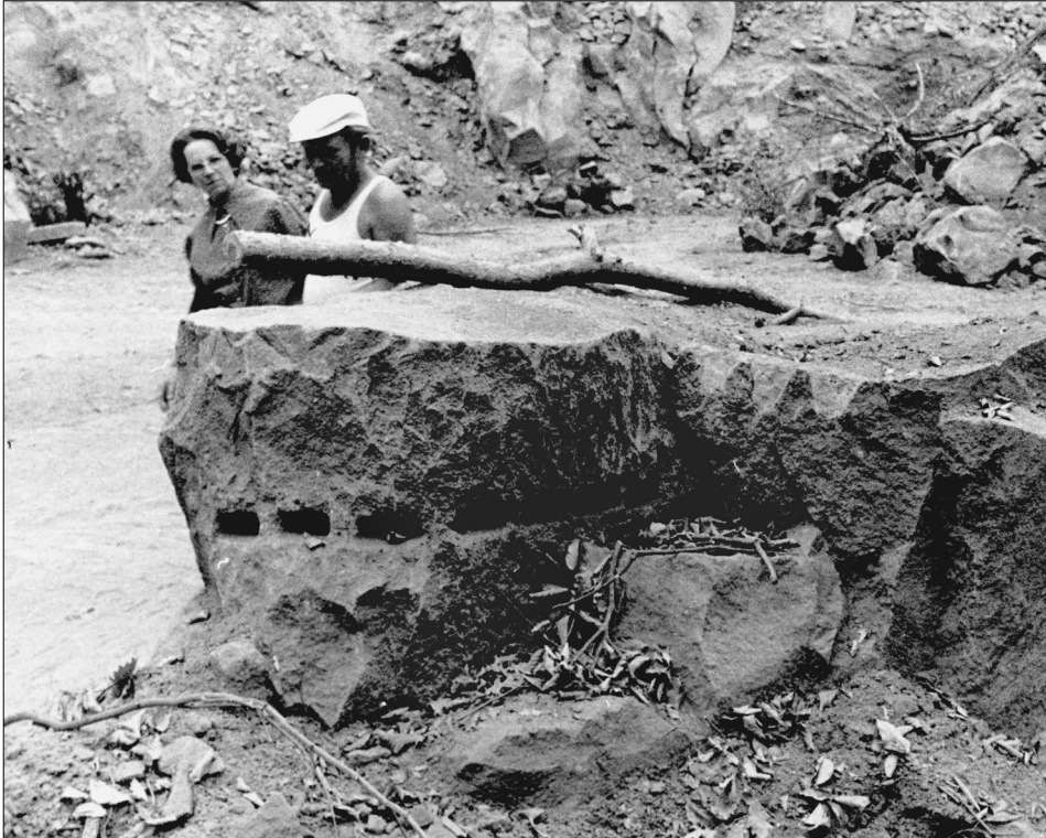
Abb. 22 Römische Mühlensteinbrüche bei Mayen, Steinbruch MAYKO 1976. Kraftmühlenproduktion: Spuren vom Bossieren des Rohlings vor dem Abkeilen. Auf dem Bild: Frau Gertrud Röder und Herr Josef Quintes. Foto: J. Parkhouse.
