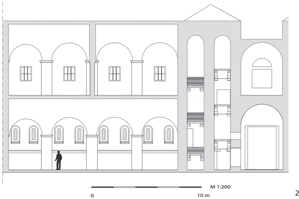
Kastron: 1 3D-Querschnitt durch Portikus und Westhalle. – 2 Westtrakt. Längsschnitt durch beide Geschosse der Westhalle, Rampenhaus und Vestibül. – (O. Hofmeister).
