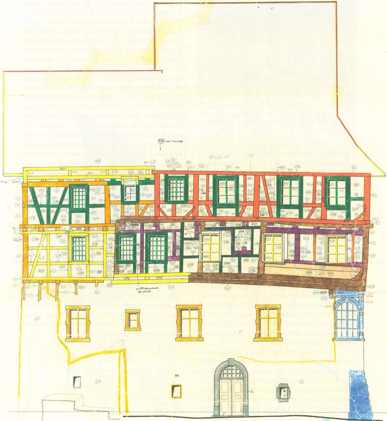
Abb. 6 Burg Zug 1799. Fassade Nord. Plan nach photogrammetrischer Aufnahme von 1970 (Originalmassstab 1:50) mit eingezeichneten Baubefunden. Reproduktionsmassstab 1:100.
