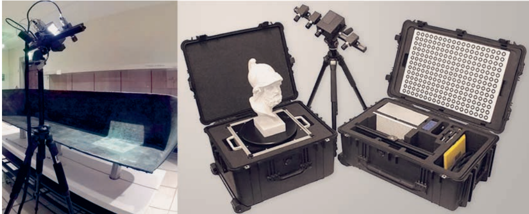
2 Links: Projektion von Streifenlichtmustern auf die „Kline“ mit Streifenlichtscanner PT-M1280. Rechts: Die Komponenten des gesamten Scan-Systems mit Scanner, Drehteller, Kalibrierplatten und Zubehör.
