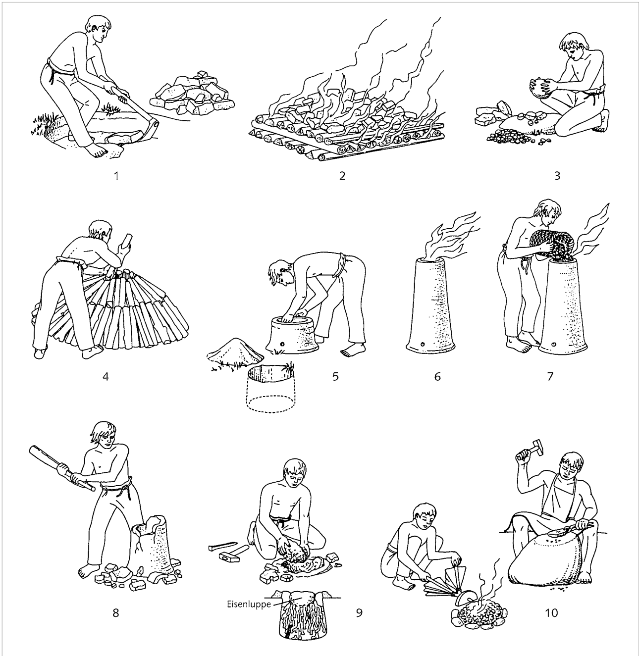
Abb. 60. Arbeitsschritte der Eisengewinnung (nach Jöns, Eisengewinnung 64 Abb. 58; Grafik: Institut für Ur- und Frühgeschichte, Kiel).
