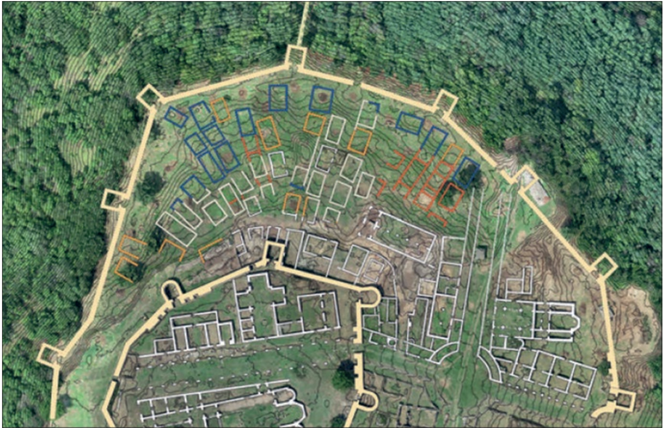
Abb. 6 Bebauungsplan der Oberstadt auf dem Nordplateau Caričin Grads. Ausgegrabene Gebäude (weiß); rekonstruierte Gebäude: LiDAR-Scans (blau), Geomagnetik (gelb) und GPR Surveys (orange). Die Gebäudegrundrisse liegen auf einem Luftbild aus dem Jahr 2014, die Höhenlinien wurden übernommen aus dem 2011 erstellten LiDAR abgeleiteten DTM. – (Nach Ivanišević, Illyricum 152 Fig. 8).
