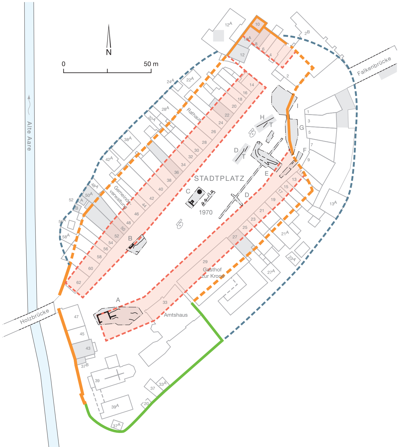
7 Aarberg (BE). Grundriss der heutigen Stadt mit den Resten der Gründungsstadt des 13. Jahrhunderts. Graues Raster: archäologisch untersuchte Areale bzw. Bauten der Stadt; orange und grün: Stadtmauer bzw. Ummauerung der Stadtburg (gestrichelte Linien: vermuteter Verlauf); rot: Häuserzeilen und Areal der Stadtburg; grau gestrichelt: mutmassliches Aareufer (Archäologischer Dienst des Kantons Bern, Katharina Ruckstuhl)
