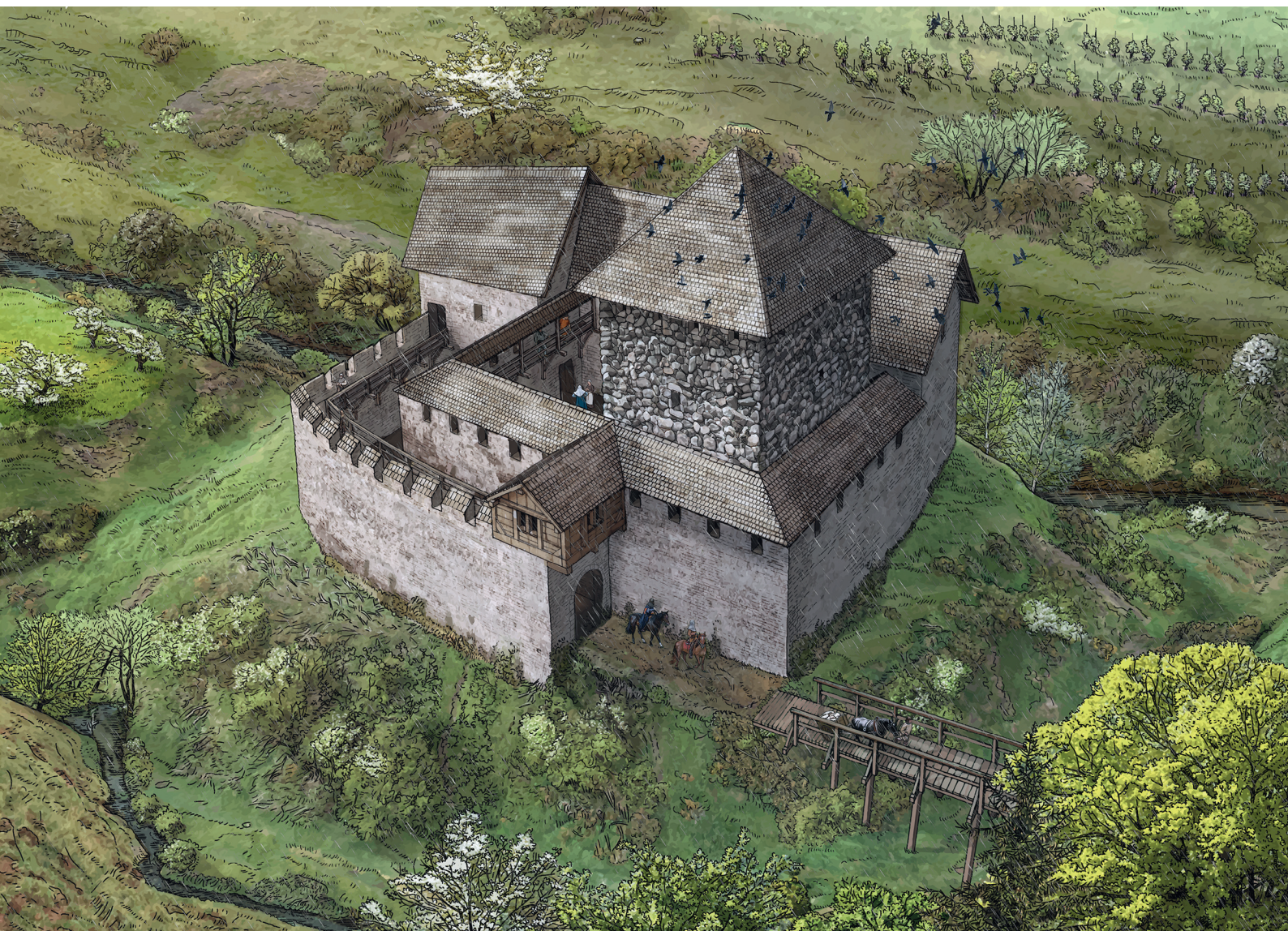
Abb. 178 Rekonstruktionsvorschlag für Bauphase III in der Mitte des 13. Jh., Blick nach Nordosten. Der Wechsel von der zweiten zur dritten Anlage stellt keine Zäsur dar, vielmehr wird die bestehende Anlage um den Bergfried ergänzt.
