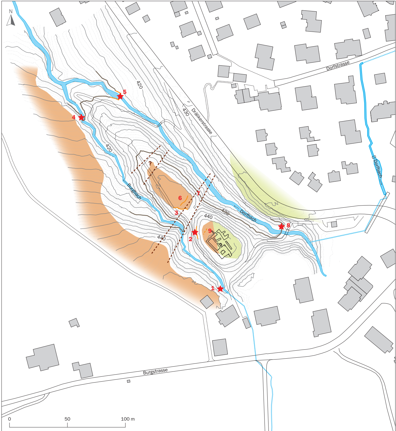
Abb. 6 Katasterplan mit den geologisch-tektonisch beurteilten Aufschlüssen 1–9. Eingezeichnet sind (mögliche) Steinbruchkanten, (vermutete) geotektonische Brüche, zwei mächtig ausgeprägte Sandsteinbänke sowie die vor Ort dokumentierte Überdeckung (mergeliger Molasselehm oder Moräne).
