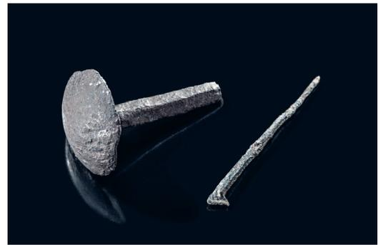
nen Blech besteht. Die Hölzer wurden durch zwei große und vier kleine Nägel fixiert, die von allen Seiten eingeschlagen wurden und so die Festigkeit der Verbindung garantieren sollten. Auch dieses Objekt entstammt der Verfüllung von Latrine 497 und gehört in die erste Hälfte des 14. Jahrhunderts.
