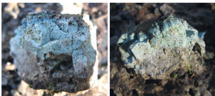
Abb. 236 Blaue (links) und türkisfarbene (rechts) Verhüttungsschlacke mit hohem Silikatanteil aus der Halde (D) der Eisenhütte auf der Schmala (Foto: LWL-Archäologie für Westfalen/F. Klatt).
