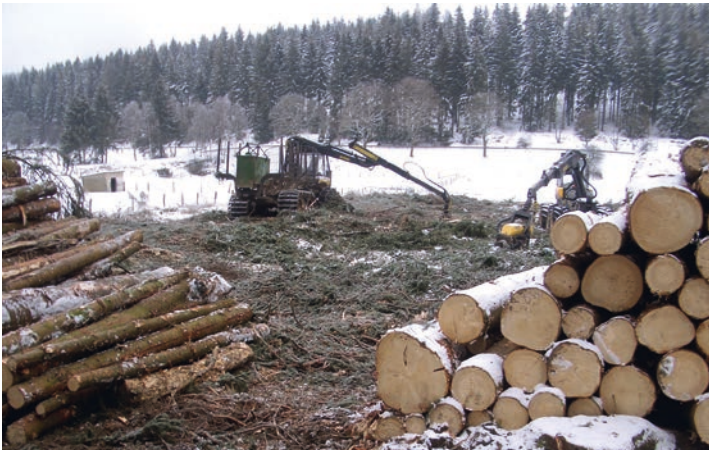
Abb. 128 Die Rodungsarbeiten am Ortsrand der Wüstung Harvelde wurden bei gefrorenem Boden durchgeführt, sodass ein Überfahren der erhaltenen Geländestrukturen mit einem Baumvollernter möglich war. Durch das Entgegenkommen der städtischen Forstbehörde blieben die unvermeidbaren Bodeneingriffe auf ein Minimalmaß beschränkt (Foto: R. Ahlers, Winterberg).
