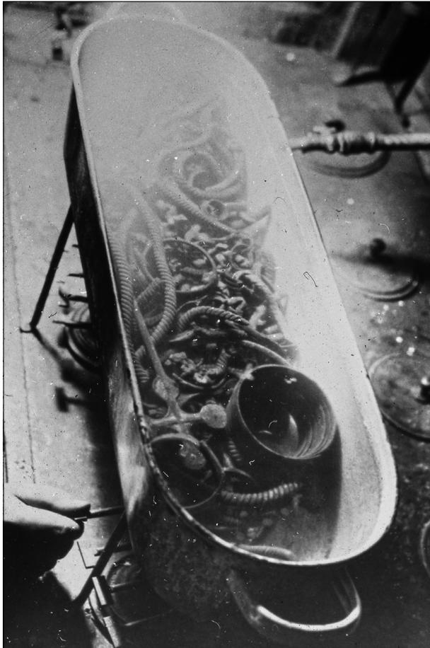
**Abb. 52** Wässerungsbad zum Auslaugen der Chemikalienreste nach der elektrochemischen Reduktion mit dem Verfahren nach Axel Krefling am Berliner Chemischen Laboratorium in den 1930er Jahren.
