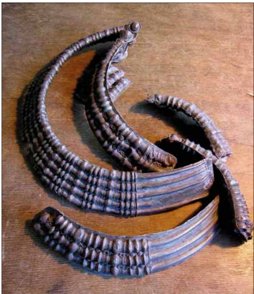
Abb. 3 Noch unbearbeitete Kupfergalvano-Rohlinge zur Herstellung der Kopien der Goldhalskragen. Foto: A. Pesch, ZBSA.
