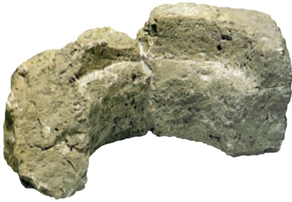
**Abb. 198** Werla, Gebäude G 3: Heißluft-Auslassstein. – (Nach Ring 2001, 19 Nr. 3).
