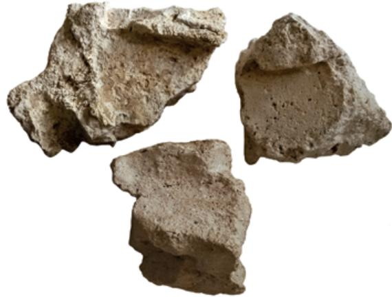
**Abb. 99** Schloss Herzberg, Torhaus: Wandbruchstücke der in Kletterschaltechnik errichteten Innenwand (2017). – (Foto M. Schenk, NLD Braunschweig). – o. M.
