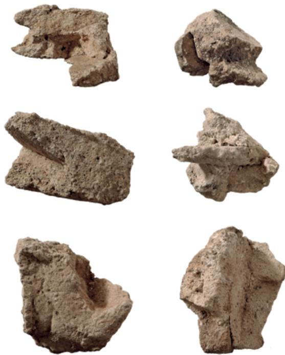
**Abb. 97** Werla, Gebäude G 2: Auswahl von Mörtelbruchstücken mit Einschlüssen von Bruchsteinen oder Staketenabdrücken. – (Foto M. Schenk, NLD Braunschweig). – M. 1:3.
