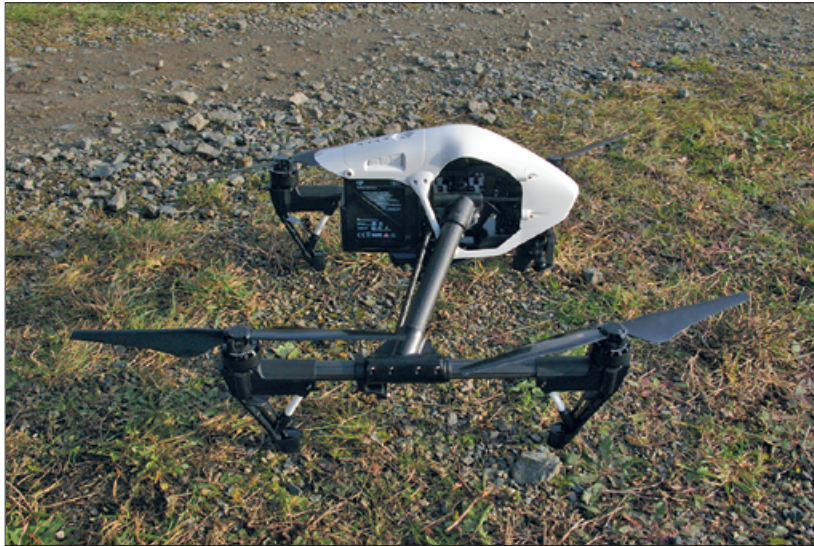
Abb. 32 Pfalz Werla: Die 2017 zur Befliegung verwendete Drohne vom Typ »Inspire 1 V2.0« des Herstellers DJI. – (Foto M. C. Blaich, NLD Hannover).
