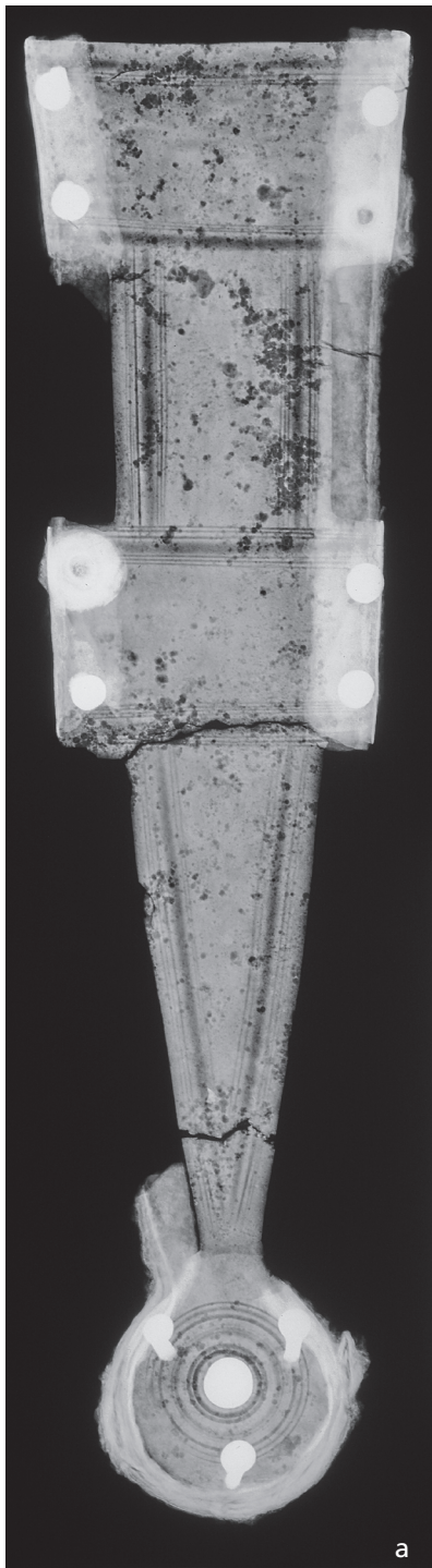
Fig. 118 a Radiografía de la vaina puñal de filos curvos ofrecido al RGZM. – (Bildarchiv RGZM R87/540).
