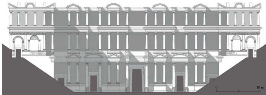
Abb. 133 Rekonstruktion des Bühnengebäudes des Theaters von Hierapolis, Zeichnung: G. Sobrà, F. Masino, Archivio MAIER, nach ISMAELLI – SOBRÀ – BOZZA – CASA – GALLI 2022, Abb. 1
