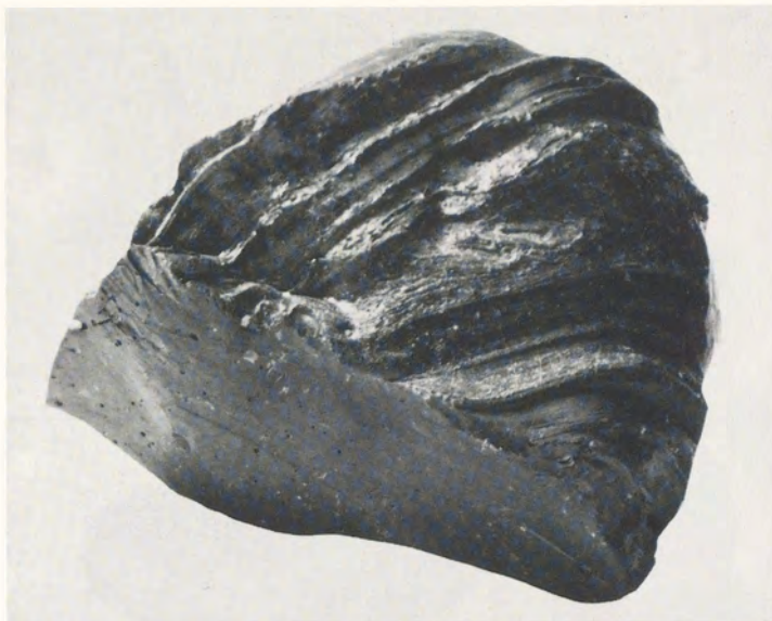
Abb. 8 Dortmund, Adler-turm. Bleisilikatschlacke mit deutlich erkennbarer Fließstruktur; (untere Bildkante 5 cm).
