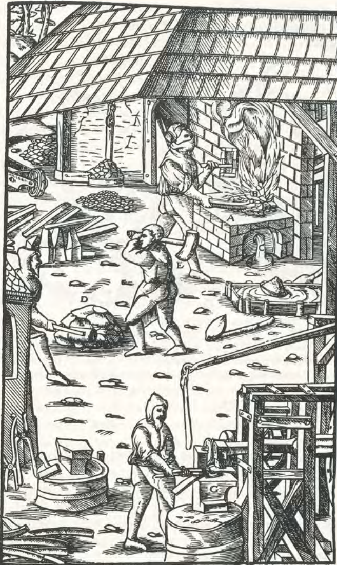
Der Herd A. Der Befückungshaufen B. Der Schlackenabfluß C. Der Eisenklumpen (Maffel) D. Die Holzhämmer E. Der große eiserne Hammer F. Der Amboß G.
