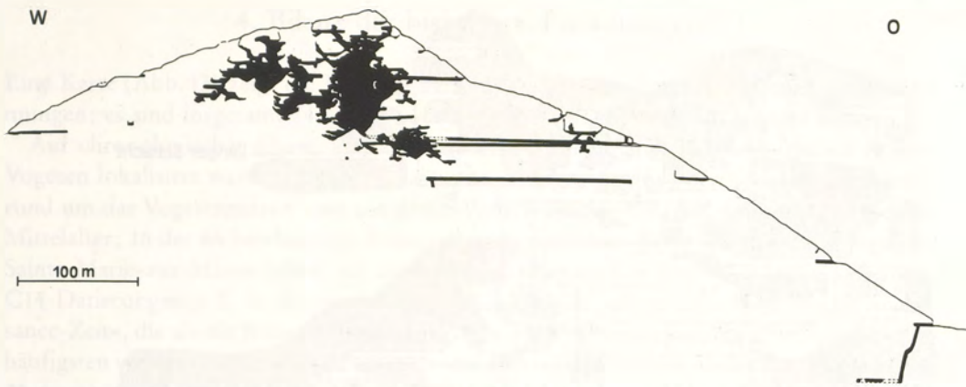
Abb. 11 Seigerriß (vereinfacht) durch die Abbaue des St. Ludwig-Ganges, Neuenberg, Sainte-Marie-aux-Mines (B. Ancel u. P. Fluck).
