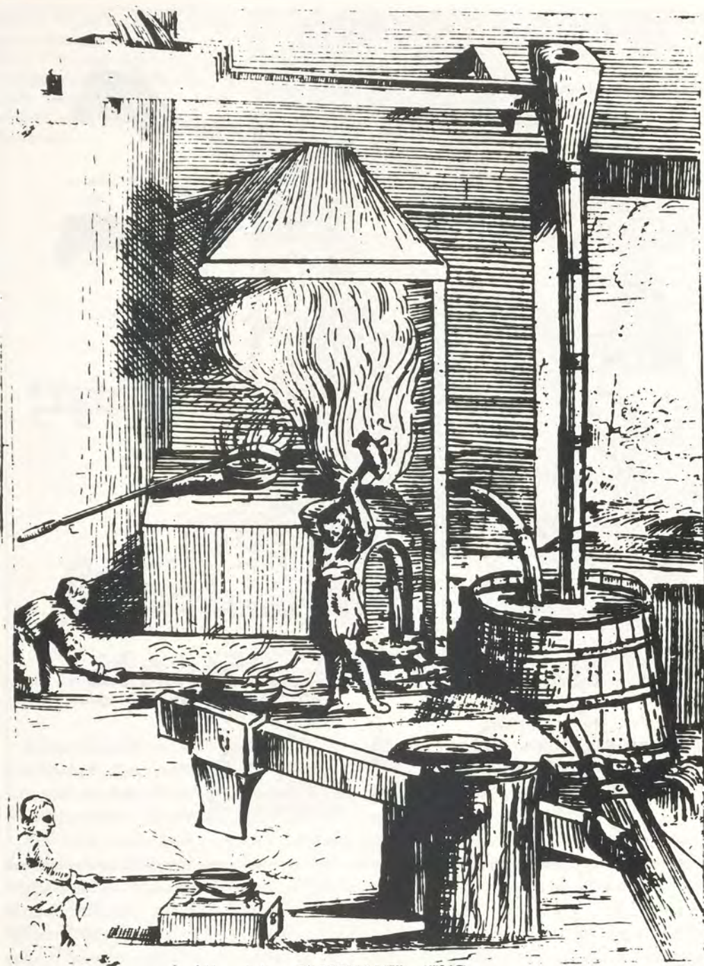
Abb.4 Catalanfeuer nach DELLA FRATTA (1678): Die im Italien des 17. Jahrhunderts übliche Konstruktion des Catalanfeuers wurde von DELLA FRATTA frei nach den Bräuchen seiner Heimat gegenüber AGRICOLA (Abb.3) umgestaltet. Die Esse mit dem Schlackenabstich ist gleichartig, die Windzufuhr hier mit dem Bottichgebläse (Tromba idroeoica) dargestellt. Statt des Aufwerfhammers ist ein Schwanzhammer abgebildet.
