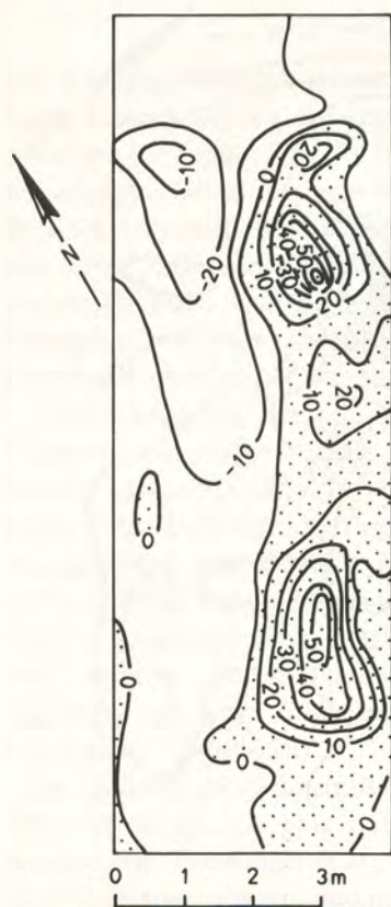
Abb. 6 Magnetische Spezialvermessung über der »Testfläche« (Abb. 3); Isanomalenabstand 10 nT.
