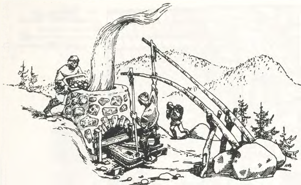
Abb. 2 Mittelalterlicher Rennofen: Die von W. SCHMID und W. SCHUSTER auf der Kreuztratte in Lölling am Hüttenberger Erzberg bzw. auf der Feistawiese 1929 am Steirischen Erzberg ausgegrabenen, mit Bruchsteinen und Lehm gemauerten mittelalterlichen Schachtöfen (SCHMID 1932, s. a. SPERL 1983) wurden von F. MAYER-BECK in Kombination mit Darstellungen des 16. Jahrhunderts rekonstruiert (SCHUSTER 1978).
