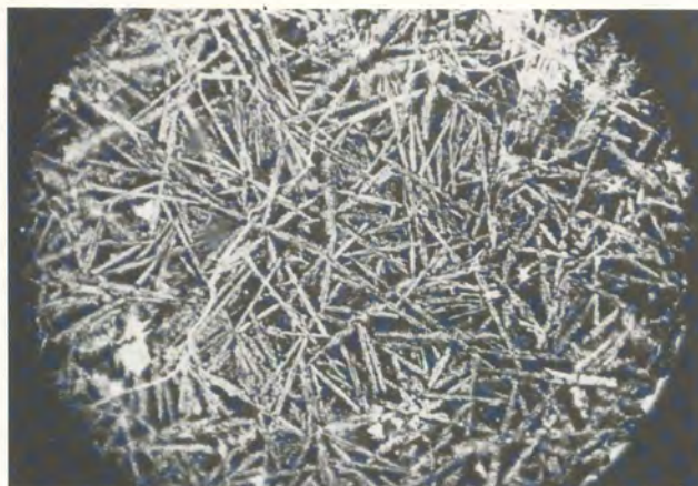
Abb. 12 Die nadelförmigen Körnchen des Olivins und Leuzits (weiß) bilden die pseudophitischen Schlackengefüge; (Durchlicht, 125:1).
