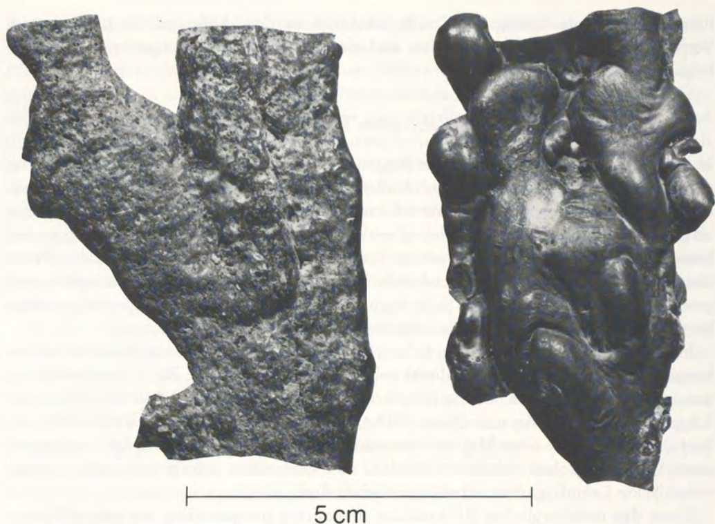
Abb. 2a Fayalitische Laufschlacken (Süs A 452) aus einer hochmittelalterlichen Kupferkiesverhüttung, Münstertal-Süßenbrunn, 11./12. Jahrhundert.
