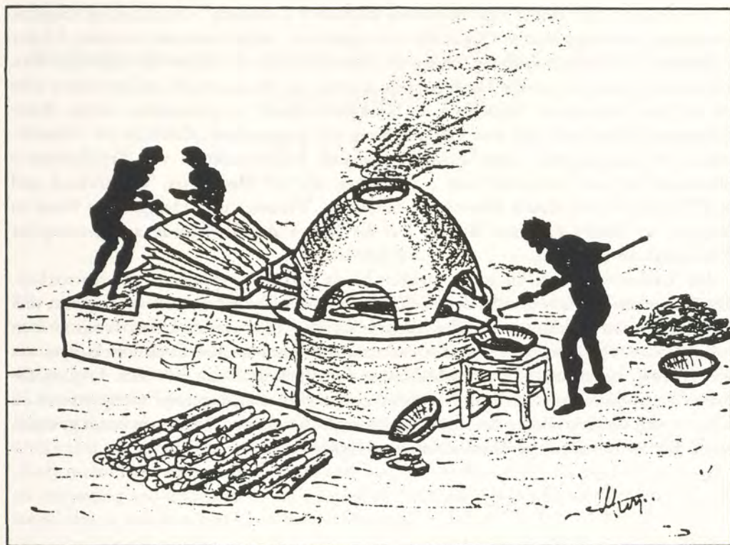
Abb.2 Rekonstruktion des »Treibprozesses mit Abstich der Bleiglätte« nach den Befunden in Laurion; 5./4. Jahrhundert v. Chr.; nach CONOPHAGOS (wie Anm. 2).
