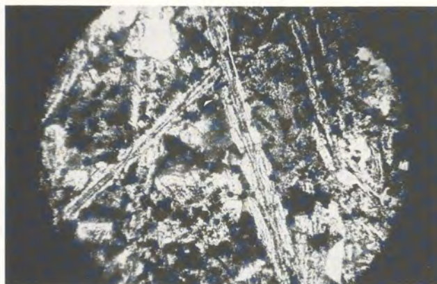
Abb. 13 Die Skelettstangen aus Olivin mit plumpen Pyroxenkörnchen und dem Glas in der Grundlage. Die weißen Partien weisen auf den Leuzit hin; (Durchlicht, 125:1).
