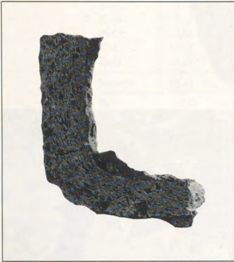
Abb. 7a und b Dortmund, Adlerturm. Tiegelfragmente mit anhaftenden Schlackenresten; (untere Bildkante 4 bzw. 5 cm).
