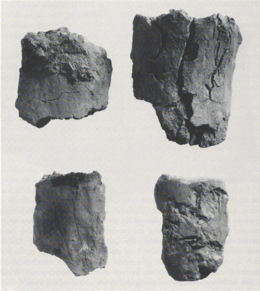
Abb.8 Metzgingen »Kurlshau«. Überreste von Windformen, stellenweise Außenseite verschlackt; erhaltene Länge 6 bis 9 cm.
