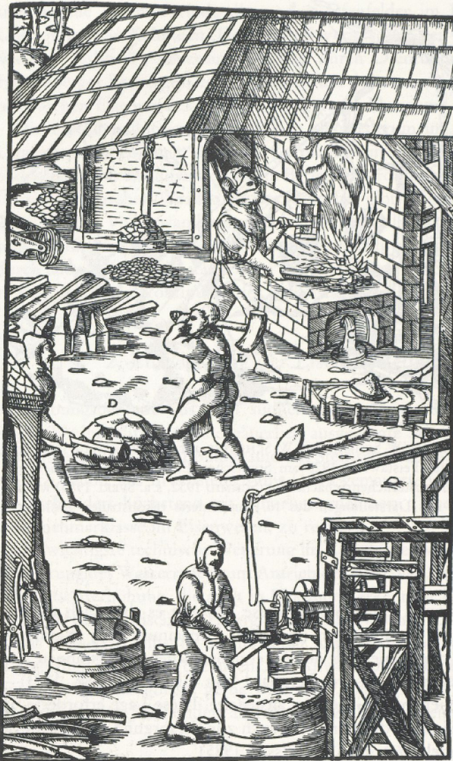
Der Herd A. Der Befickungshaufen B. Der Schlackenabfluß C. Der Eisenklumpen (Maffel) D. Die Holzhämmer E. Der große eiserne Hammer F. Der Amboß G.
