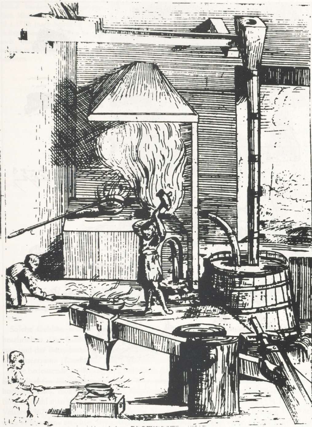
Abb.4 Catalanfeuer nach DELLA FRATTA (1678): Die im Italien des 17. Jahrhunderts übliche Konstruktion des Catalanfeuers wurde von DELLA FRATTA frei nach den Bräuchen seiner Heimat gegenüber AGRICOLA (Abb.3) umgestaltet. Die Esse mit dem Schlackenabstich ist gleichartig, die Windzufuhr hier mit dem Bottichgebläse (Tromba idroeolica) dargestellt. Statt des Aufwerfhammers ist ein Schwanzhammer abgebildet.
