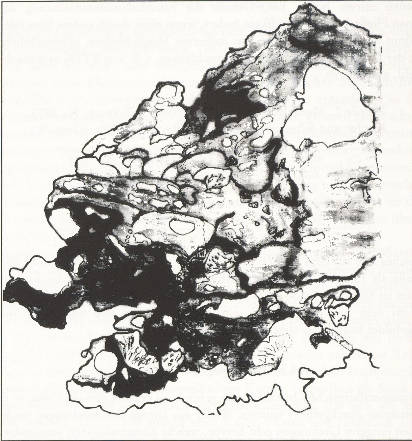
Abb.7 Querschnitt durch einen Schlackenkegel (Corta Lago). Sehr heterogene Schlacke mit zahlreichen Gesteins- und Holzkohle-Einschlüssen. Große Gasblase unter der Kegelspitze. Nach einer Handpause vom Original. Verkleinerung auf 1/2.
