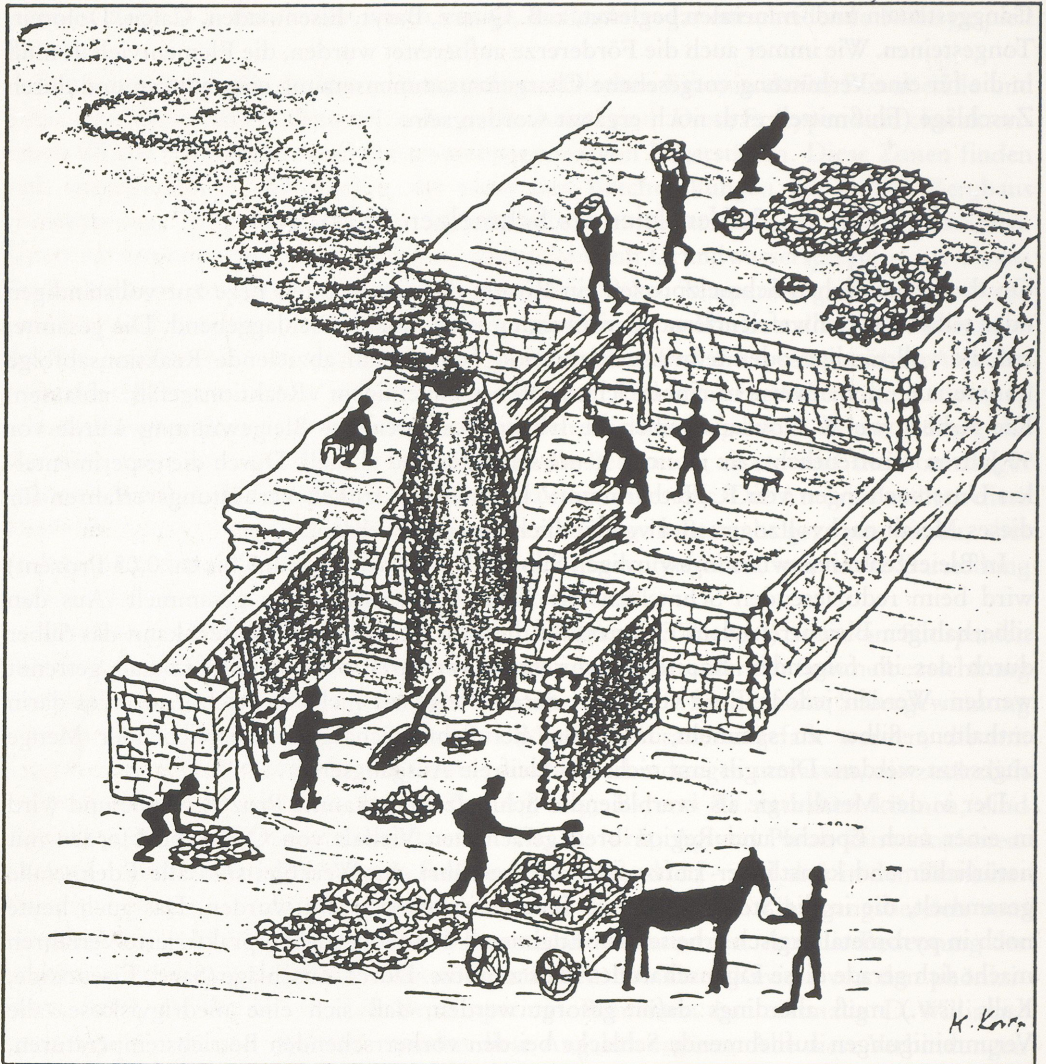
Abb. 1 Rekonstruktion des »verbleienden Schmelzens« im Schachtofen; nach Funden in Panormos, südl. Laurion; 5./4. Jahrhundert v. Chr.; nach CONOPHAGOS (wie Anm. 2).
