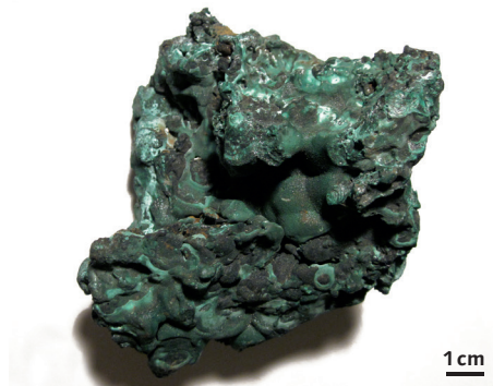
Abb. 112 Ein Stück Schiefer mit Malachitkruste aus der Grube Oscar, Kilianstollen, Marsberg. Zur Verfügung gestellt von G. Rosenkranz (Foto: K. Nowak-Klimscha).
