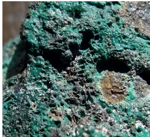
Abb. 58 Blasenbildung an der verbliebenen Malachitkruste als Nachweis der Verhüttung (Foto: G. Rosenkranz, Marsberg).
