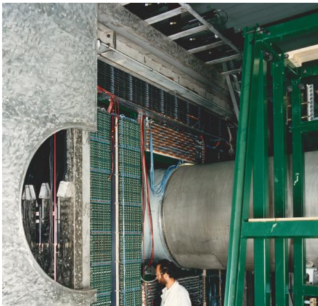
Abb. 7. Eingangsseite des Antineutron-Detektors, mit (von innen) Trigger- und Vertex-Detektoren, Kalorimeter und Veto-Szintillatoren.
