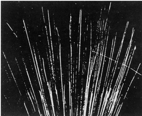
Abb.1: Künstliche Kernumwandlung. Nebelkammeraufnahme des Prozesses {}_{7}^{14}\text{N} + {}_{2}^{4}\text{He} \rightarrow {}_{8}^{17}\text{O} + {}_{1}^{1}\text{H} kurz {}_{7}^{14}\text{N}(\alpha, p){}_{8}^{17}\text{O} . Aufnahme P.M.S. Blackett u. D.S. Lees, Proc. Roy. Soc. A 136, 325 (1932).
