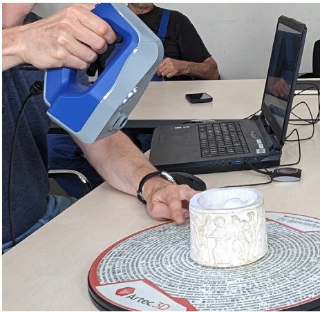
Abb. 2a Digitalisierung eines Objekts aus der christlich-archäologischen Sammlung der FAU mit tragbarem 3D-Scanner. Foto: U. Verstegen, 2023. Abb. 2b Visualisierung des digitalisierten Objekts auf der Plattform Sketchfab. Screenshot, 2025.
