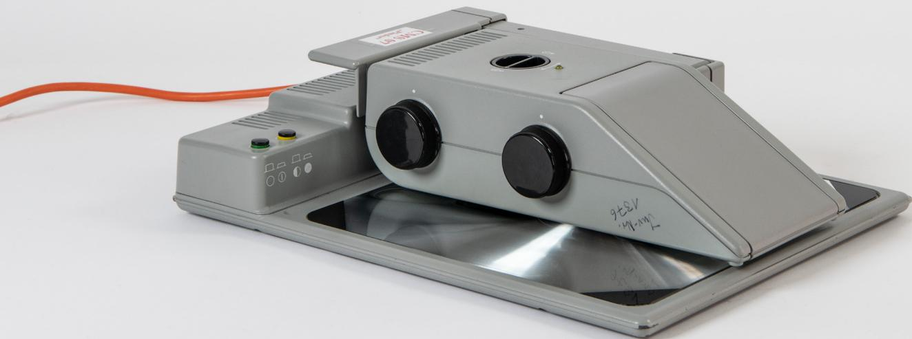
Projektionssäule, wodurch bei unvorsichtiger Verwendung die Möglichkeit des selbstständigen Zusammenklappens besteht. Die Hitzeentwicklung der Lampe im Kopf ist groß, so dass an beiden Geräten das schwarze Plastik am Gewinde angeschmolzen ist.
