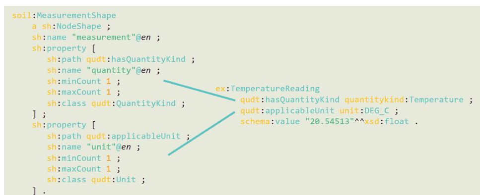
Abbildung 2: Links das Metadatenprofil einer Messung, rechts ein valider Messwert eines Temperatursensors. Das Profil bedingt dabei die zwei Eigenschaften, das Vorhandensein einer Größe samt Einheit.
