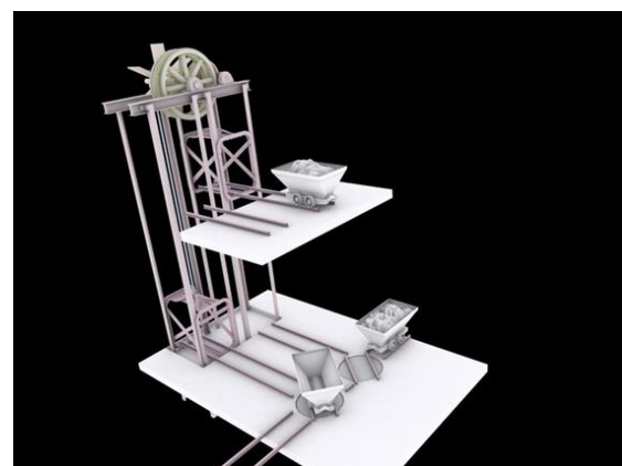
Abb. 5 Virtueller Nachbau der Fördertechnik in einem Bergwerkschacht
