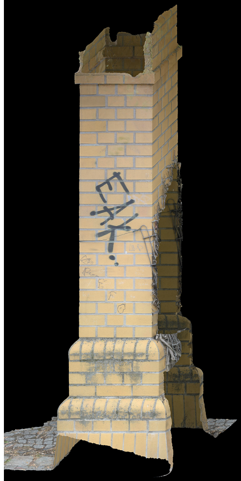
Abb. 4 Beate Gütschow, Beispiel eines fotogrammetrisch aufgezeichneten Gegenstands, dessen fotografische Hülle Löcher aufweist
