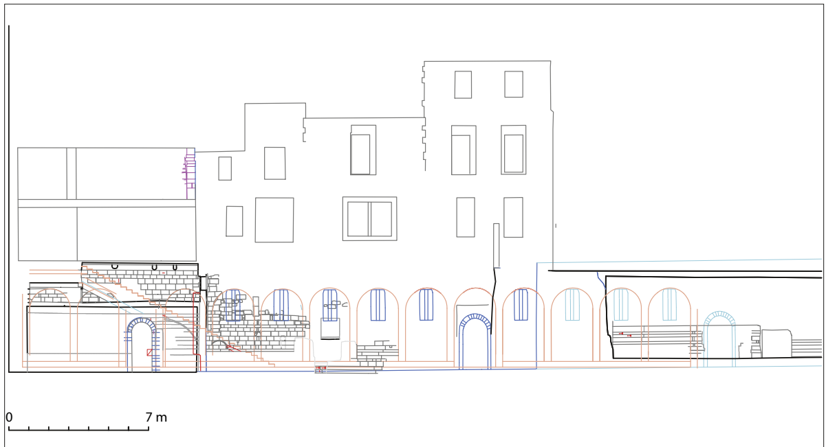
4 Ehemaliger Kreuzgang, tachymetergestütztes Teilaufmaß der Ostfassade des Westbaus mit Ansatz und Rekonstruktion einer geplanten Verlängerung der Westgaleriearkade nach Westen sowie der mutmaßlich Anfang des 13. Jahrhunderts eingebauten Treppenanlage (2014–2021).
