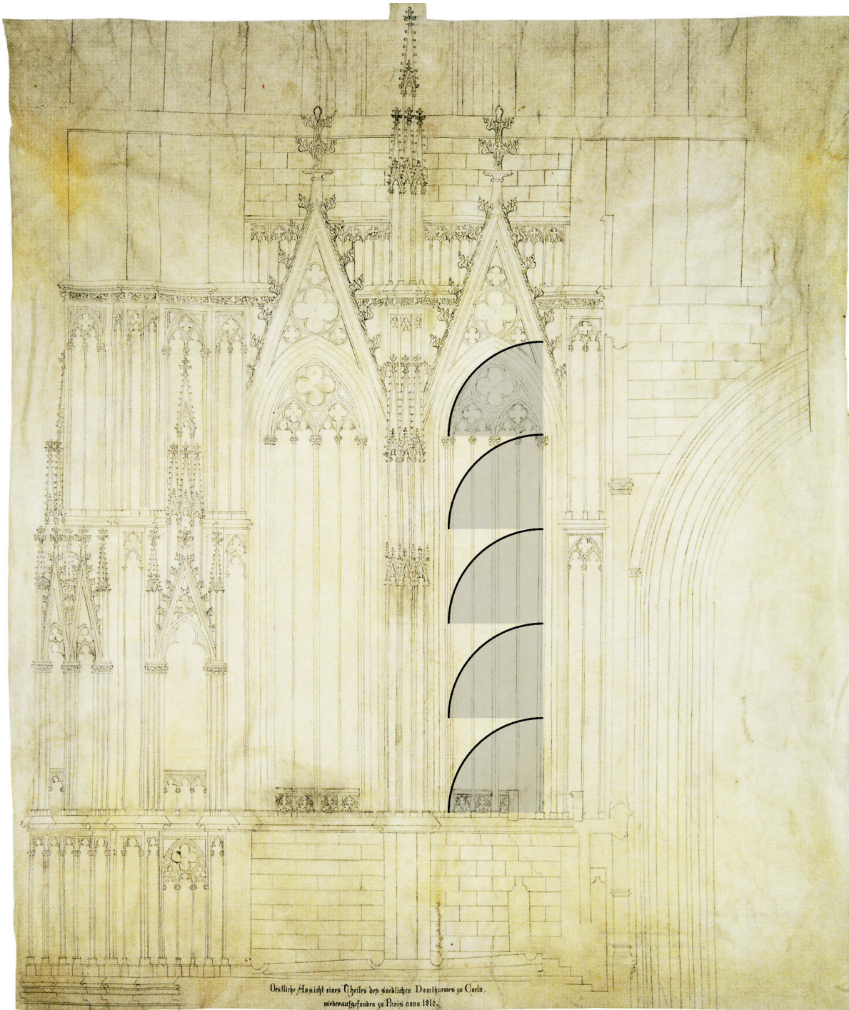
4 Riss E des Kölner Domes, Außenaufriß des unteren Turmgeschosses. Fensterproportionierung durch fünf Zirkelschläge über die Konstruktionsbreite des Fensters.
