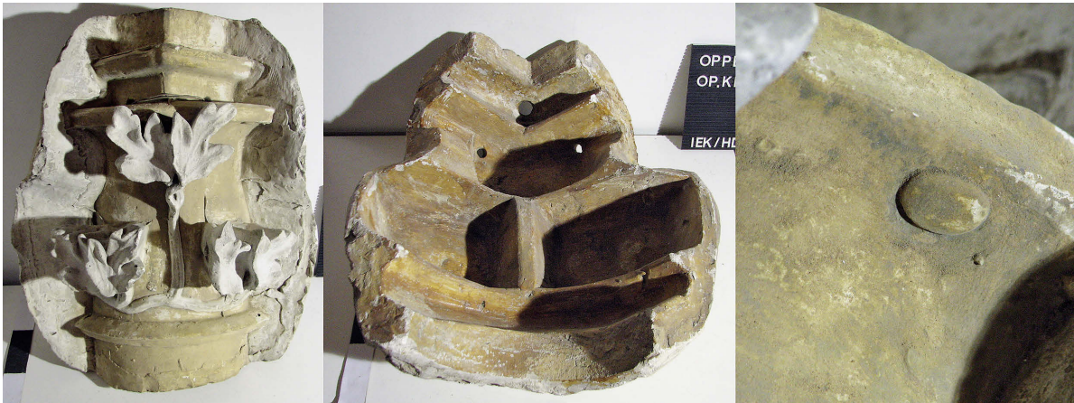
7 Gips eines Langhauskapitells der Katharinenkirche Oppenheim mit zugehöriger Gusschale; rechts: überschüssiger Gipsrest am Kapitell an der Stelle des Gusskanals.
