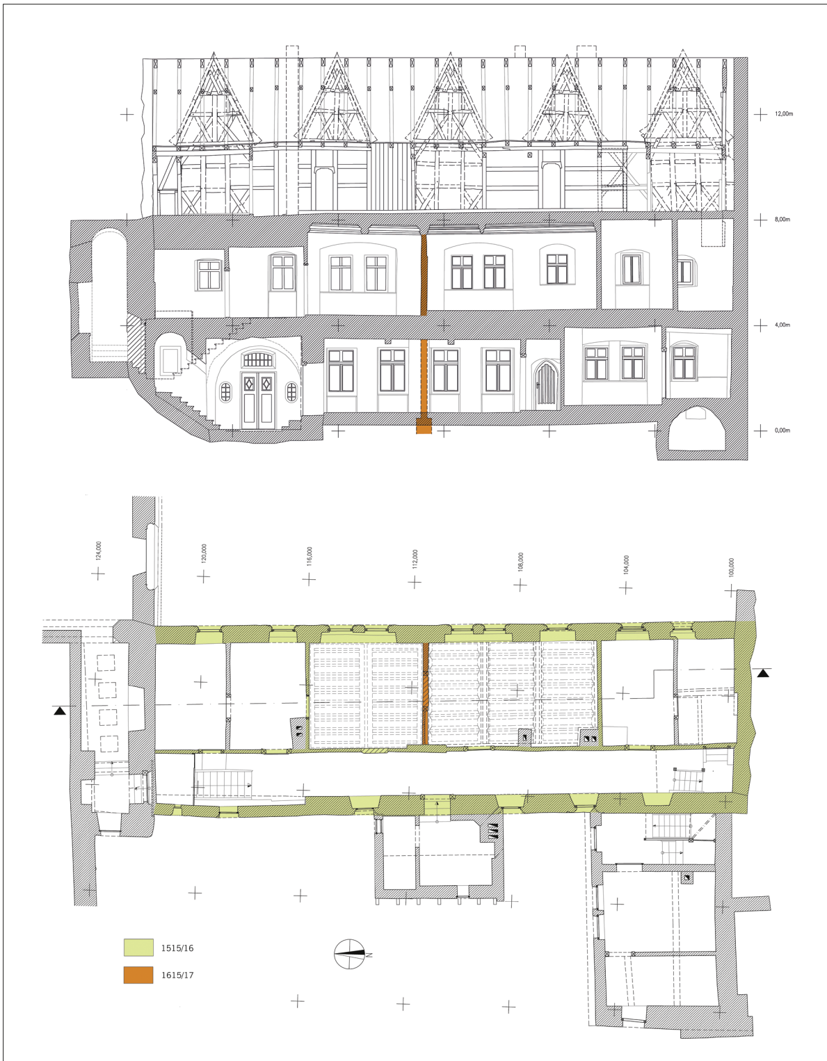
13 Klausurflügel. Schnittzeichnung Nord-Süd und Grundriss des Obergeschosses mit Eintragung der dortigen Trennwand im ursprünglich großen Raum und dem Fundament sowie zwei Stützen im Erdgeschoss als Substruktion für die genau darüber eingebaute Trennwand im Obergeschoss (Bauphase 3).
