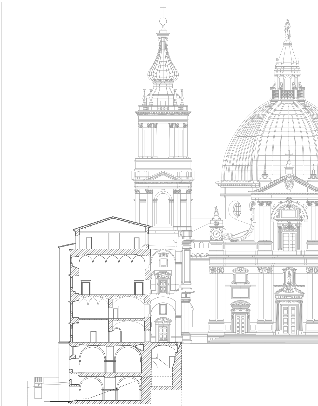
Dis. 9 Palazzo Apostolico - Loreto Sezione A-A Individuazione delle strutture riferibili al progetto di Bramante
