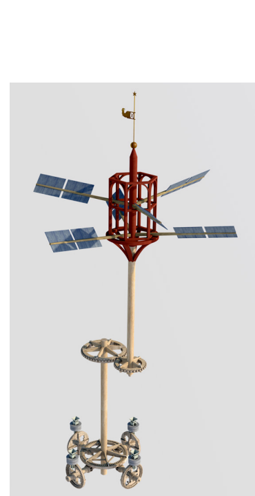
□ 09 3D-App Hohentwiel, Interaktives Teilmodell Räderwerk der Horizontalmühle (Staatl. Schlösser u. Gärten Baden-Württemberg, J. Hanschke, Micromovie).
