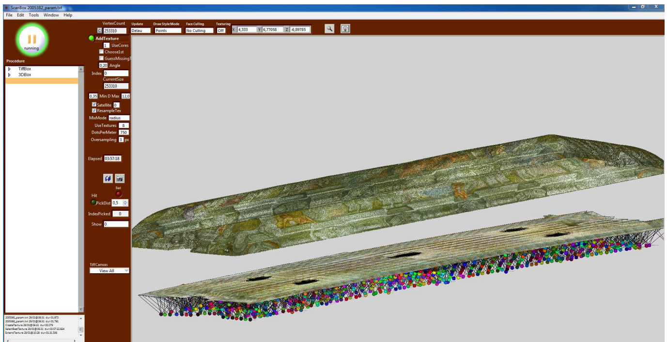
□ 02 Berechnung der Messbilder zum Bamberger Kaisersaal zu exakten Orthobildern.
