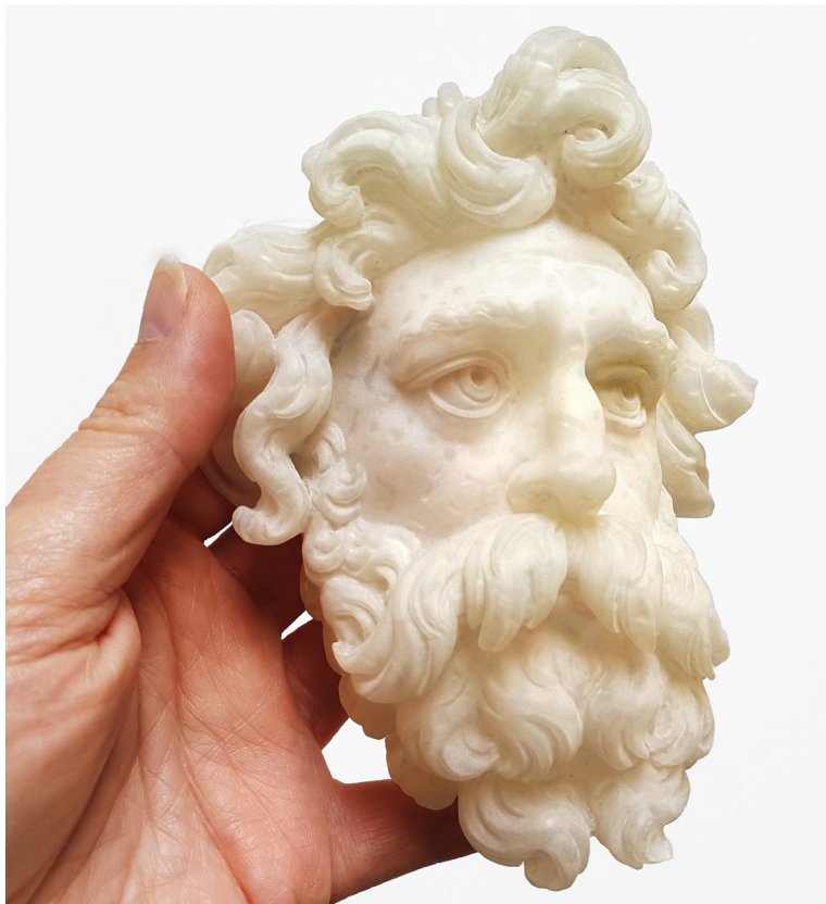
□ 05 Stereolithographie-Harz-Modell der Brunnbach-Maske im Maßstab 1:2 (Joerg Maxzin, THD).
