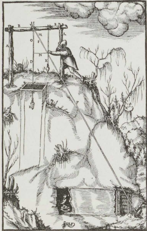
Abb. 18. Messung von Schachttiefen mittels Schnurdreieck (aus G. AGRICOLA (Anm. 128)); Foto: Deutsche Fotothek Dresden)
