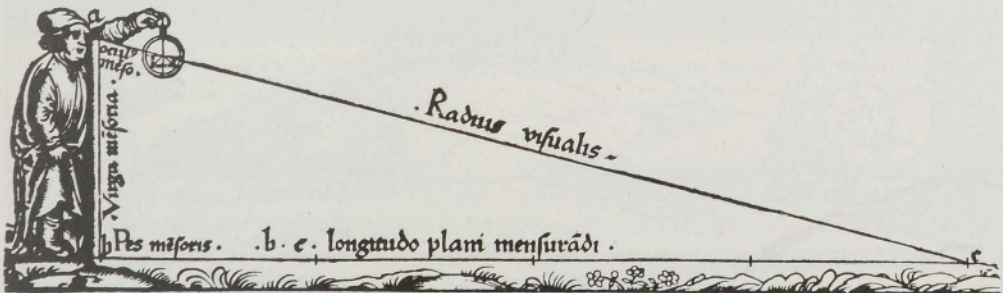
Abb. 9. Entfernungsmessung mit Hilfe eines Astrolabiums (aus J. STÖFFLER (ANIM. 43))
