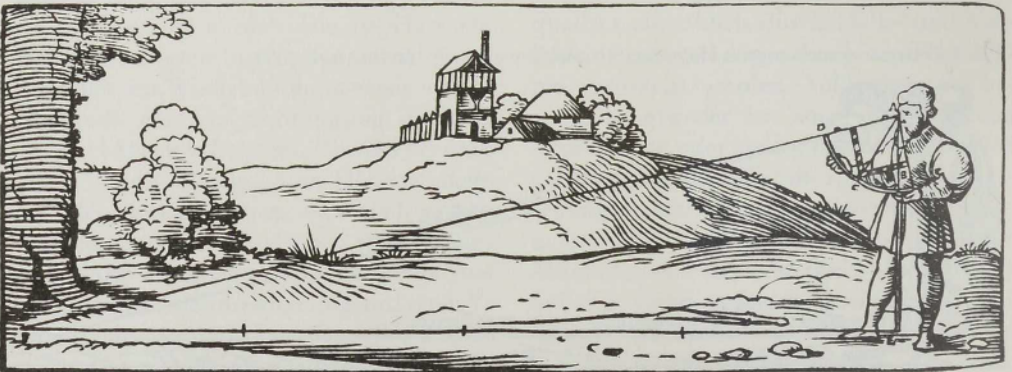
Abb. 11. Anwendung des Quadranten zur mittelbaren Streckenmessung (aus W. RYFF (Anm. 46))
