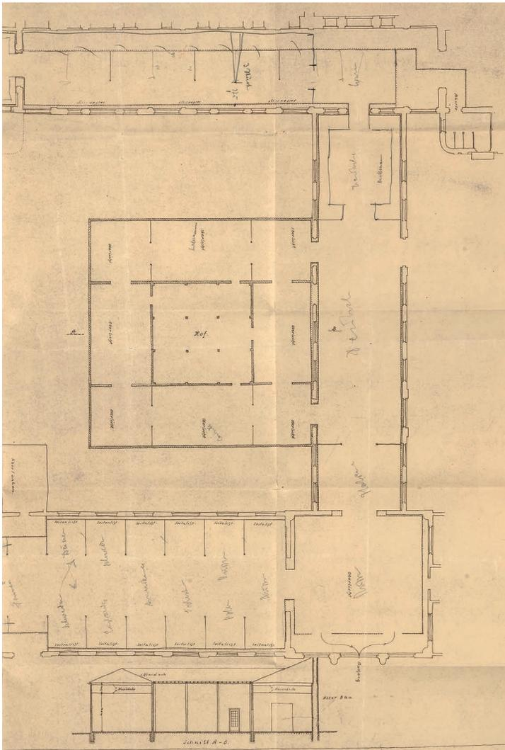
**Abb. 5** Grundriss des Städtischen Ausstellungspalastes (Ausschnitt), 1925/26, mit Darstellungen des Anbaus von Heinrich Tessenow; unten: Raumfolge 29 bis 31 im Schnitt
