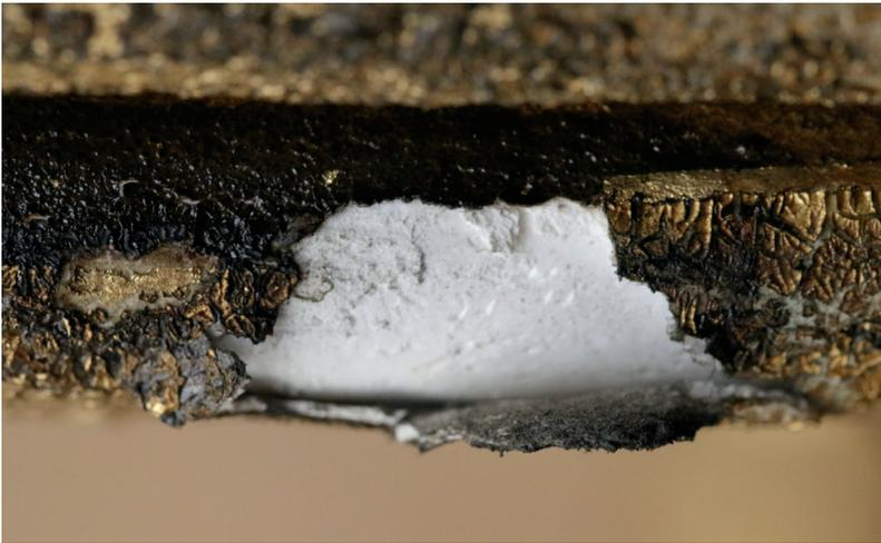
Abb. 3: Nahaufnahme des Schadensbildes mit fehlendem Sikkativ in der Staatsoper (nach 1945).
