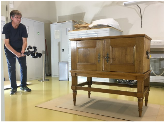
Abb.4: Digitalisierung des Möbels mittels Schwebestativ
