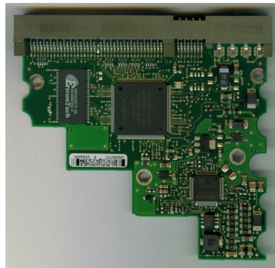
Abb. 1: Controller-Einheit für eine Festplatte (Dies ist also kein vollständiger Computer!)
