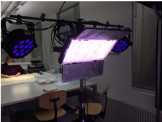
Abb. 2: Beleuchtung: Flächenleuchte Weiß für die Farbaufnahme und UV-Effektleuchten für die UV-Aufnahme
