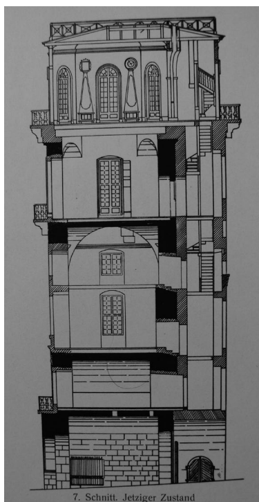
Abb. 68 Schnitt des Zwehrenturmes
