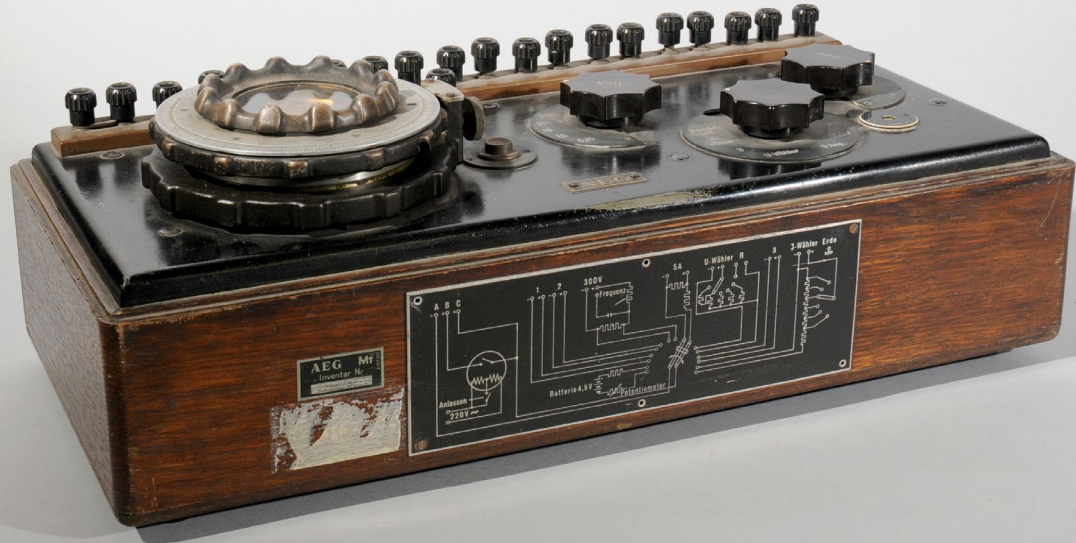
83 Vektormesser mit Schaltplan, AdA, PD152
