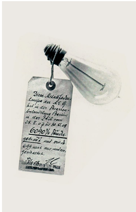
Metallfadenlampe der Berliner Straßenbeleuchtung, (6090 3/4 Stunden gebrannt)
