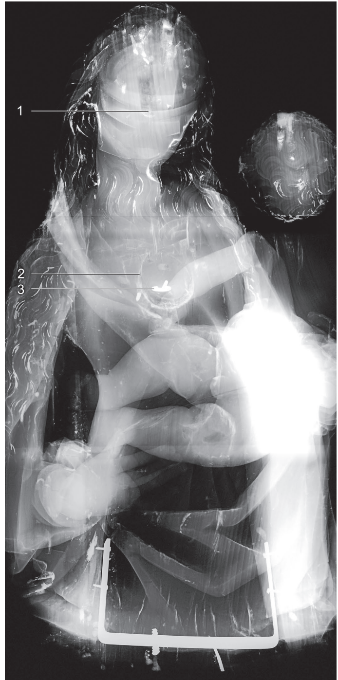
Abb. 5 Muttergottes, Röntgen-Aufnahme mit Markierungen des Dübels (1), des verschlossenen Depositoriums (2) und einer rückseitigen Öse (3)
