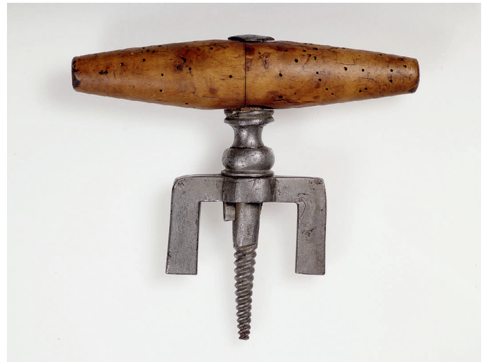
Abb. 16 Ähnlich einer Figureschraube einzuschraubendes Werkzeug, angeblich aus dem Büttnerhandwerk, Deutschland, 17./18. Jahrhundert. Nürnberg, Germanisches Nationalmuseum
