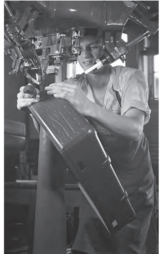
Abb. 85: Die Rollschere schneidet die Kofferplatten, Firma Lehmann, Neukirch, um 1939. Ruth Hallenseleben/ © Fotoarchiv Stiftung Ruhr Museum.
